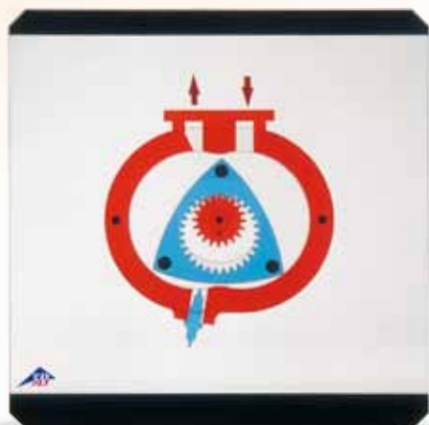
Moteur Wankel (moteur à combustion avec piston)
