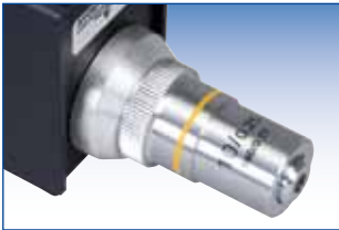
Élargissement du rayon laser à l'aide d'un objectif de microscope
