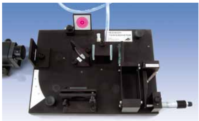
Cellule à vide dans la marche du rayon de l'interféromètre de Michelson
