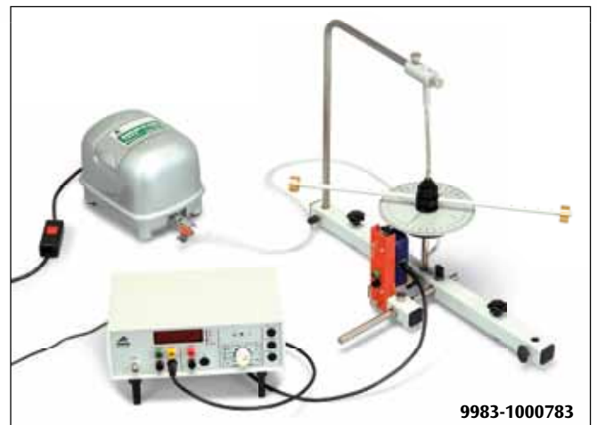
Mesure des périodes d'oscillations tournantes harmoniques à l'aide d'un compteur numérique
