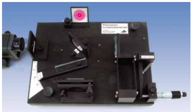
Plaque en verre dans la marche du rayon de l'interféromètre de Michelson
