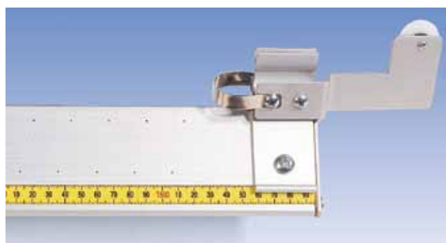
Extrémité droite du banc avec ressort et poulie de renvoi
