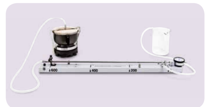
Fig. 3 Montage avec un générateur de vapeur
