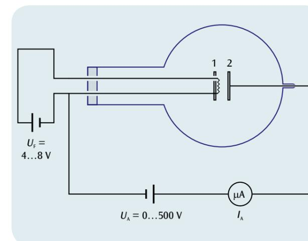
Fig. 1 Montage permettant d'enregistrer la caractéristique d'une diode
