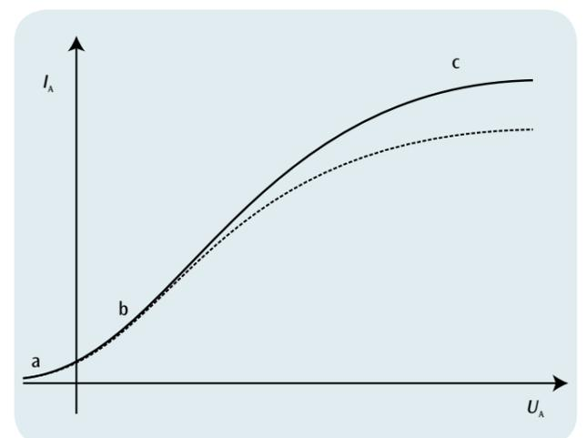
Fig. 2 Caractéristique d'une diode
