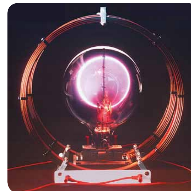
Fig. 2 Tube à pinceau étroit avec trace lumineuse circulaire des électrons dans le champ magnétique
