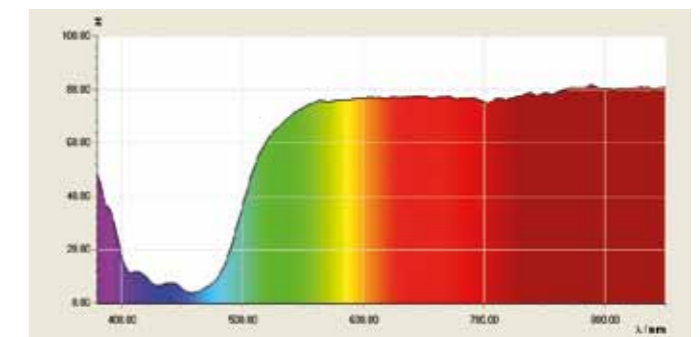
Fig. 2 Spectre de transmission d'un film couleur jaune
