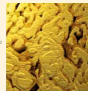
Caractérisation physique d'une surface de TaS<sub>2</sub> avec des ondes de densité de charge statiques
