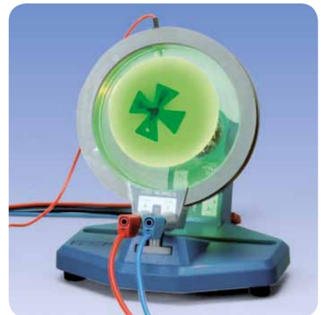
Fig. 2 Rotation de l'ombre électronique par la déviation des électrons dans le champ magnétique axial
