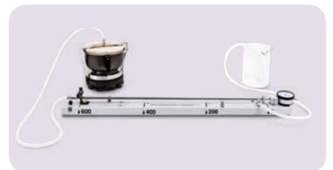
Fig. 3 Montage avec un générateur de vapeur
