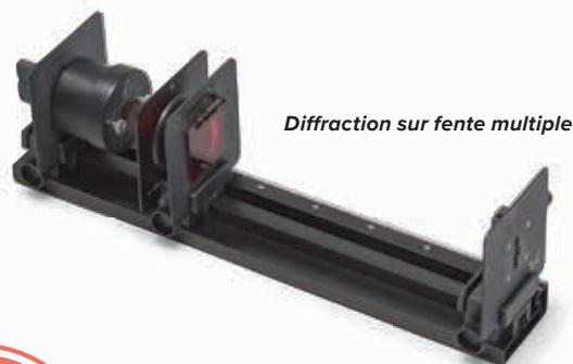
Diffraction sur fente multiple
