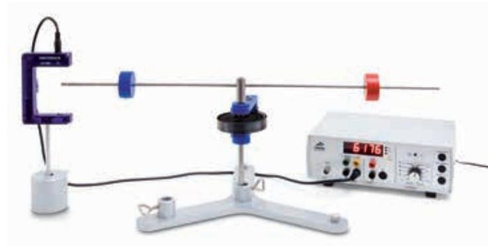
**Le moment d'inertie  $J$  des masses dépend du carré de l'écart des masses  $r$**
