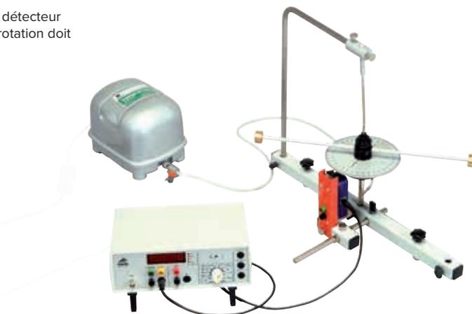
Mesure de la durée d'oscillation et détermination du moment d'inertie
