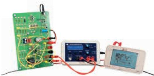
Tracé de la courbe de résonance d'un circuit oscillant RLC en série
