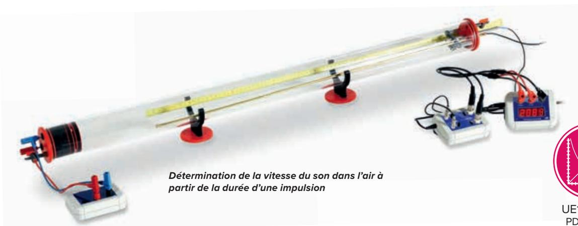
Détermination de la vitesse du son dans l'air à partir de la durée d'une impulsion
