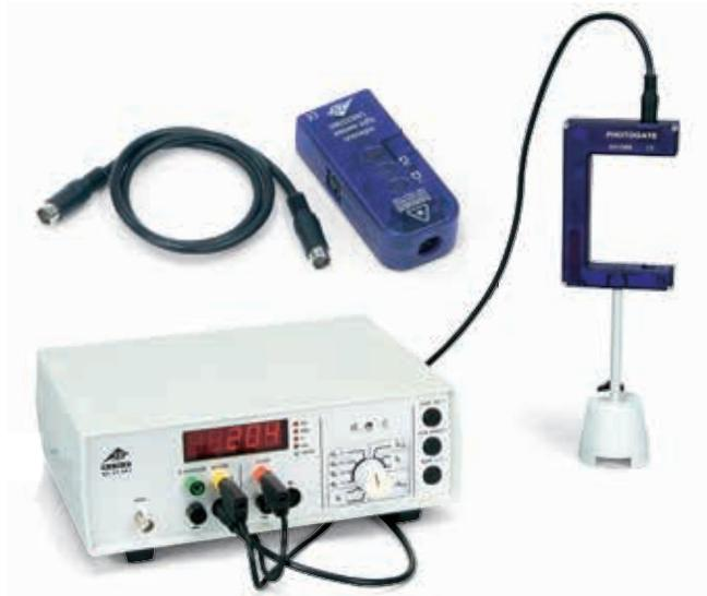
*Permet de mesurer par exemple le temps d'une oscillation d'un pendule oscillant*
