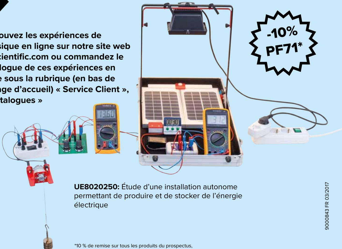
**UE8020250:** Étude d'une installation autonome permettant de produire et de stocker de l'énergie électrique
