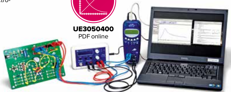
Tracé de la courbe de résonance d'un circuit oscillant RLC en série
