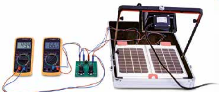
Résistance de charge idéale en cas d'angle de rayonnement modifié
