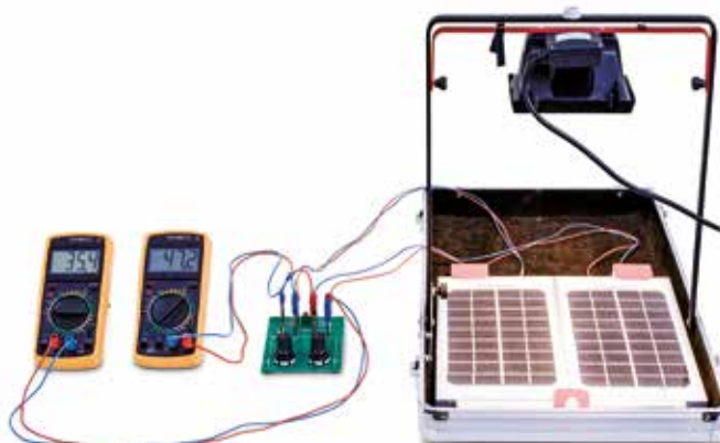
Caractéristique courant-tension en circuit série
