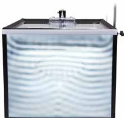
Réfraction des ondes d'eau sur une lentille convergente
