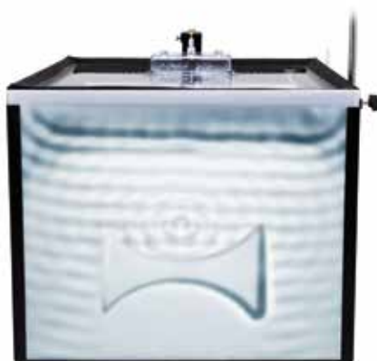
Réflexion des ondes d'eau sur un miroir concave
