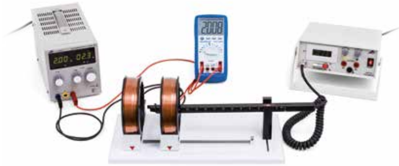
Mesure du champ magnétique sur une paire de bobines à distance variable
