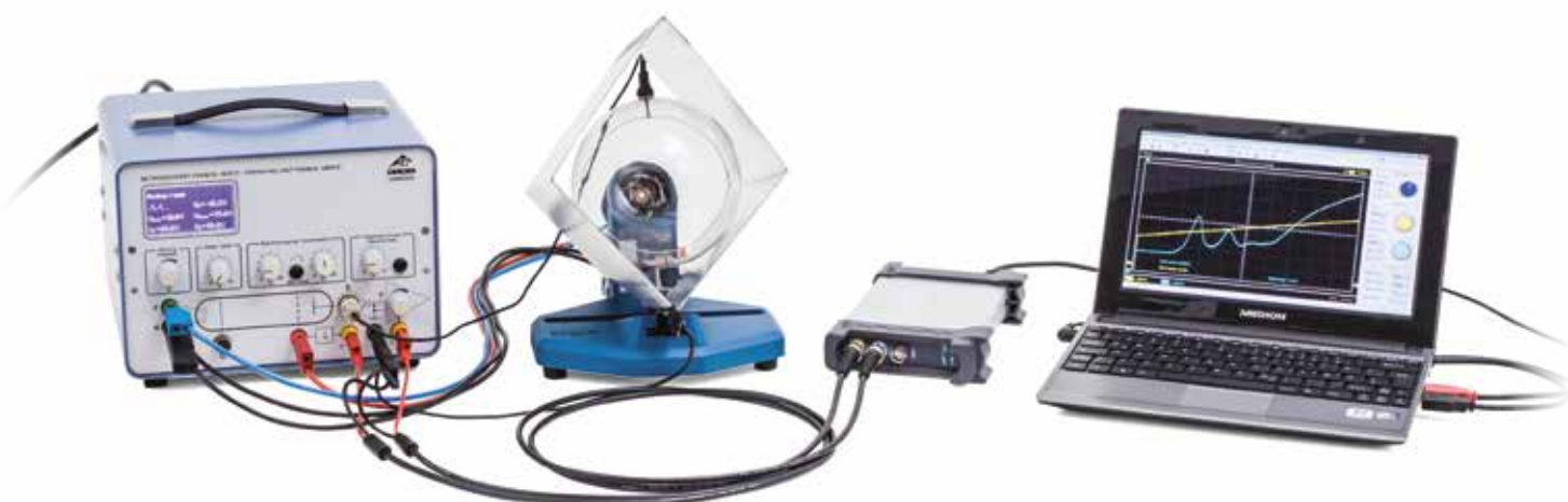
Montage expérimental avec l'appareil pour l'expérience de Franck-Hertz
