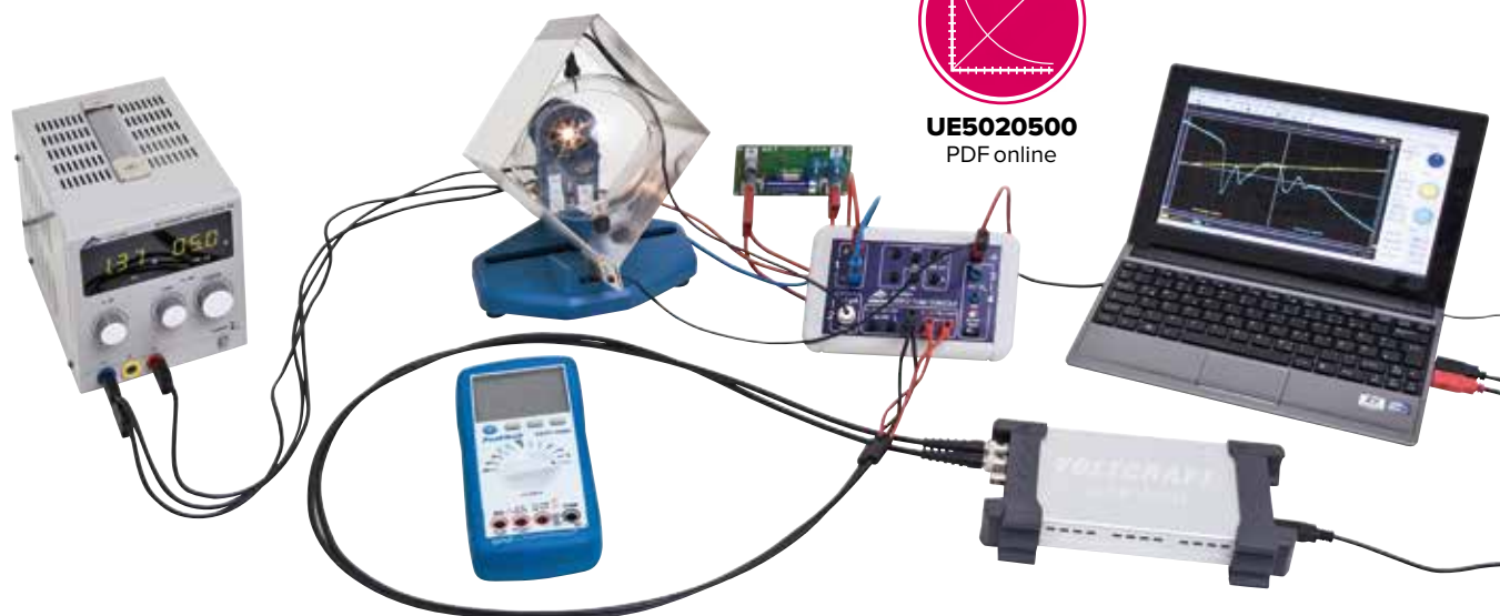
Montage expérimental avec l'unité de commande pour tubes à potentiels critiques
