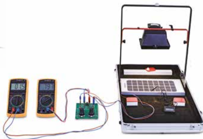
Rapport entre la température et la puissance des modules solaires
