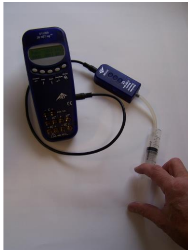
Fig. 1 Mesure de la pression absolue en fonction du volume
