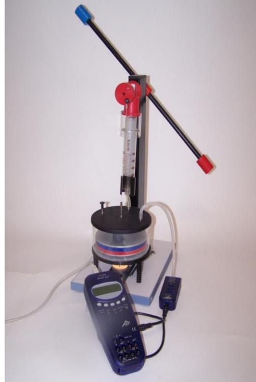
Fig. 1 Montage de l'expérience destiné à l'enregistrement des valeurs de pression de service dans le moteur Stirling D en rotation
