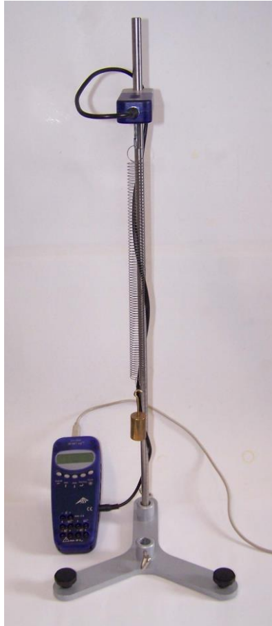
Fig. 1 Mesure des oscillations dans un système faiblement amorti de ressorts et de poids
