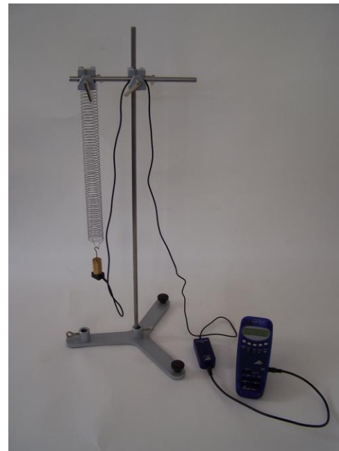
Fig. 1 Mesure de l'accélération dans un système amorti-oscillant de ressorts et de poids
