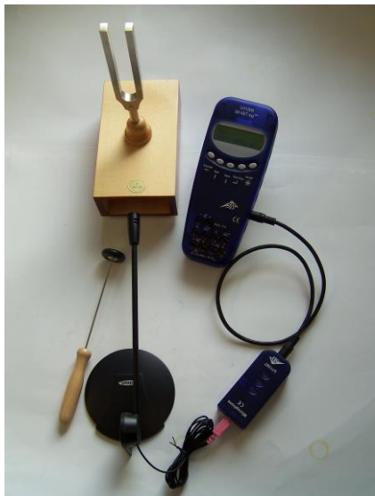
Fig. 1 : Mesure de l'onde sonore d'un diapason
