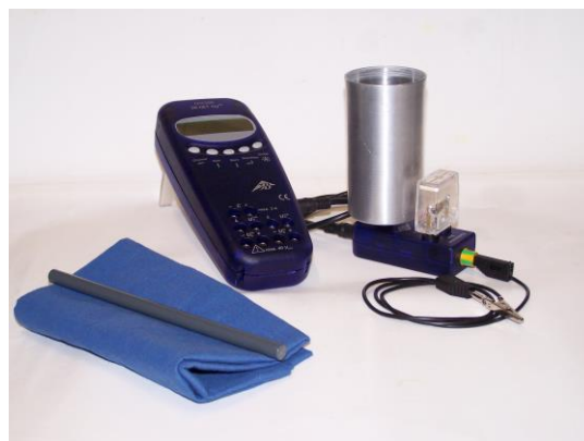
Illustration 1 :Appareillage expérimental permettant de mesurer des charges en électrostatique
