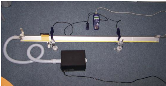
Fig. 1 : Mesure de la vitesse d'un patin sur la piste à coussin d'air pour une distance prédéfinie des barrières photoélectriques
