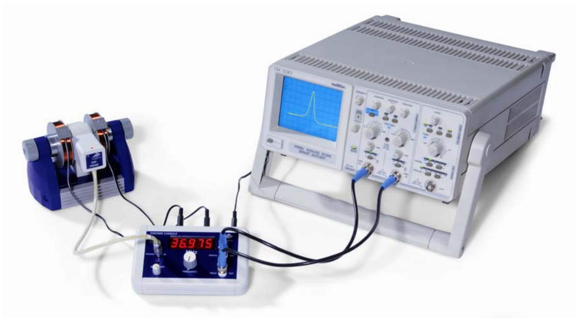
Fig. 5 Montage expérimental RSE avec un oscilloscope
