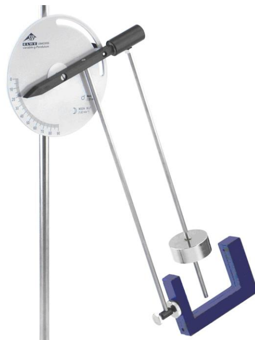
Fig. 1 Pendule gravitationnel variable avec le support et une barrière photoélectrique
