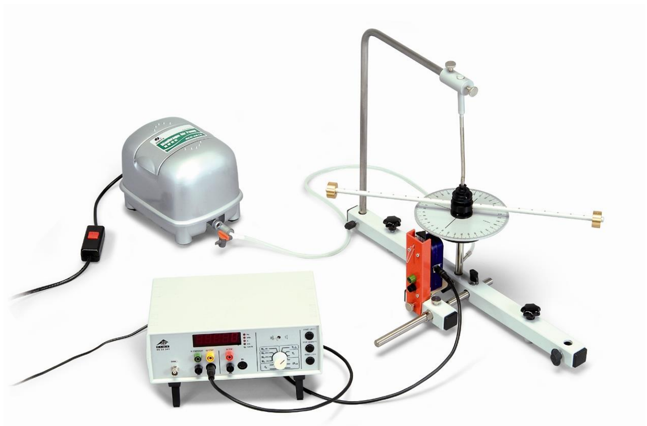
Illustration 2 Montage expérimental permettant de déterminer le moment d'inertie d'une barre haltère avec masses supplémentaires en utilisant le capteur réflectif à laser (1001034) et le compteur numérique (1001032 ou 1001033)
