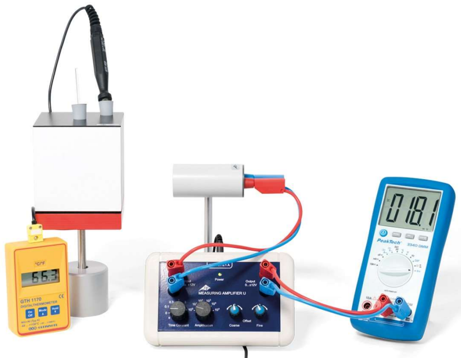
Fig. 1: Disposition expérimentale du cube de Leslie.
