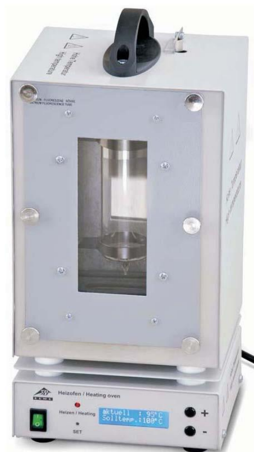
Fig. 1 Plaque frontale équipée du tube fluorescent au sodium montée sur le four
