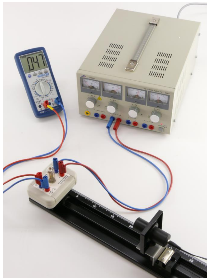
Fig. 2 Montage expérimental de démonstration de l'effet photoélectrique
