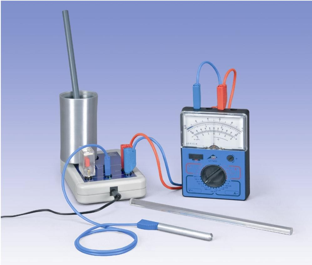
Fig. 1 Appareillage expérimental permettant de mesurer des charges en électrostatique
