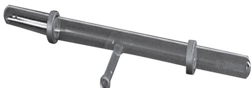
Le tube à décharge permet d'observer les phénomènes lumineux lors des décharges électriques dans des gaz à pression réduite ainsi que d'étudier les rayons cathodiques et les canaux qui apparaissent à basse pression hors du trajet de la décharge.
