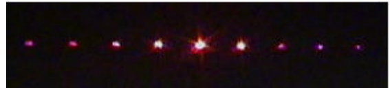
Fig. 7 Structures de diffraction d'un réseau de diffraction
