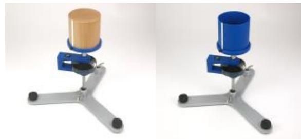
Fig. 5 Comparaison des moments d'inertie de cylindres
