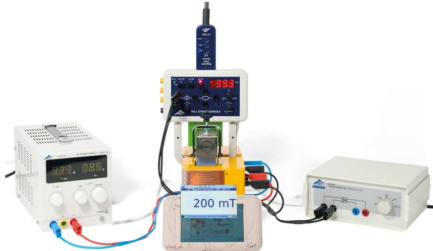
Fig. 9: Montage expérimental sur l'effet Hall avec champ magnétique homogène
