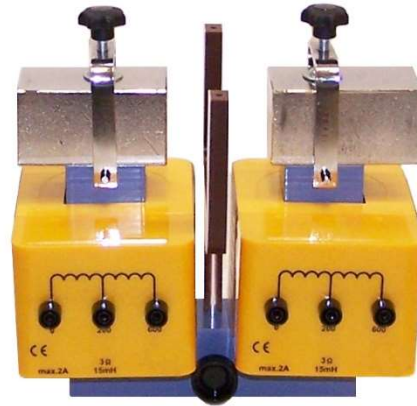
Fig. 4: Montage sur le noyau en U avec les bobines, les épanouissements polaires et le support en U
