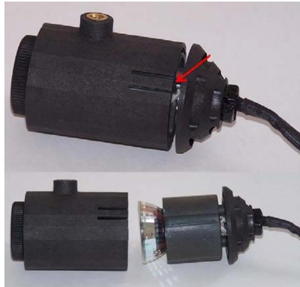
Fig. 1 Remplacement de la lampe de l'éclairage incident
