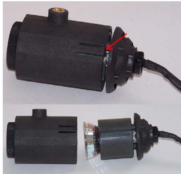
Fig. 1 Remplacement de la lampe de l'éclairage incident
