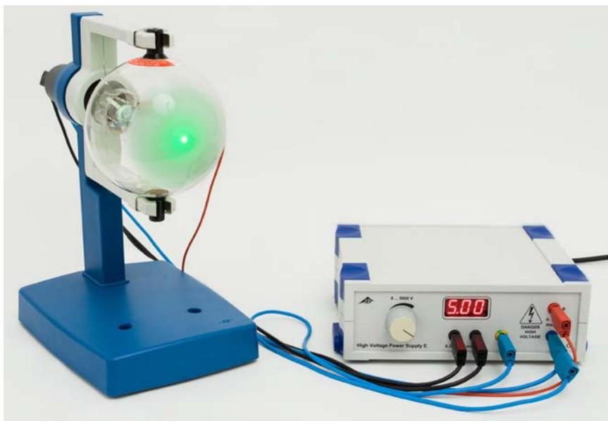
Fig. 2 Fonctionnement du tube à diffraction d'électrons
