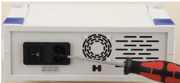
Fig. 1 Remplacement de fusible
