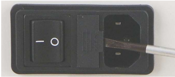
Fig. 3: Remplacement de fusible
