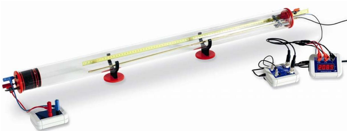
Fig. 1 Montage expérimental avec le tube de Kundt
