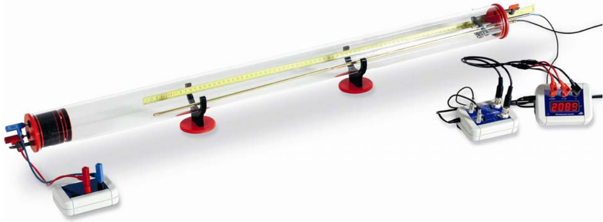
Fig. 2 : Montage expérimental avec le tube de Kundt
