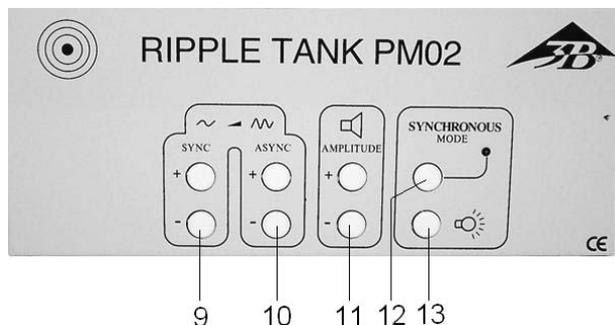
9 Boutons de réglage pour régler la fréquence excitatrice en mode synchrone
