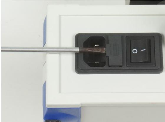
Fig. 1 Remplacement de fusible
