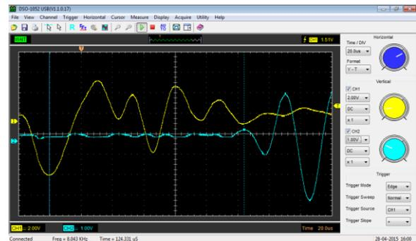
Fig. 5 Oscillogramme d'une onde transversale dans une tige en acier inox de 400 mm
