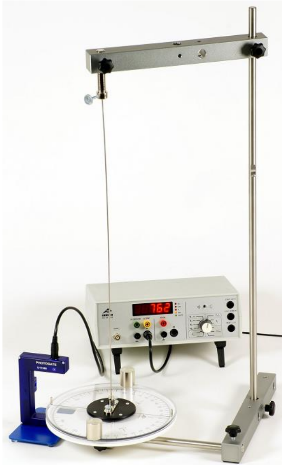
Fig. 10 : Mesure dynamique avec une barrière lumineuse et un compteur numérique.
