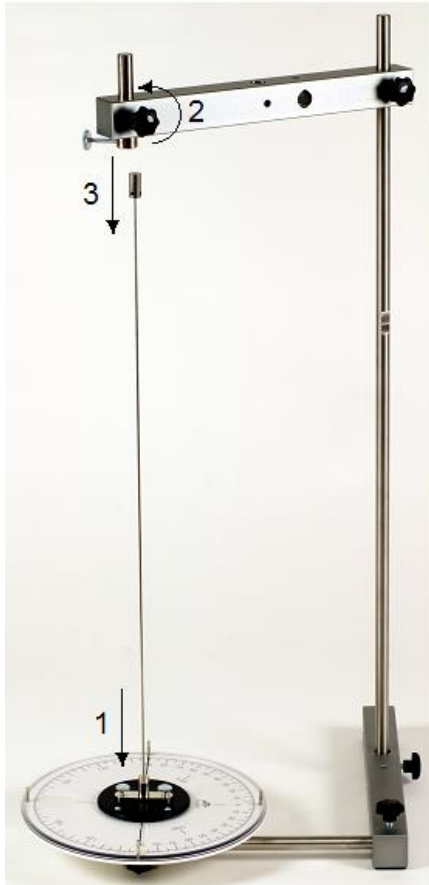
Fig. 5 : Vissage de la baguette ronde sur le balancier à l'aide de l'arceau de fixation et enfilage de la douille de serrage sur le cylindre à douille de serrage.
