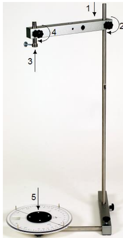
Fig. 4 : Montage de la traverse supérieure (pour baguette ronde avec L : 500 \text{ mm} ), de la douille de serrage et du balancier.
