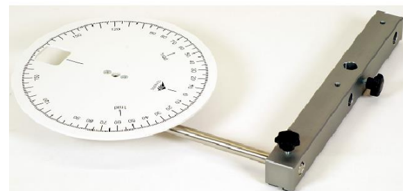
Fig. 2 : Montage du disque gradué et de la traverse inférieure sur la barre transversale.
