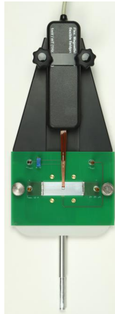
Fig. 1 : Support combiné avec platine à échantillon et capteur de champ magnétique
