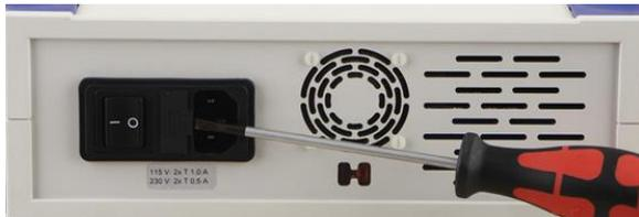
Fig. 2 Remplacement de fusible
