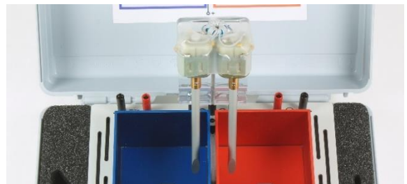
Fig. 2 : Unité de mélange connecté avec mini-agitateurs montés
