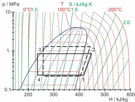
Fig. 5 Représentation du cycle idéal de la pompe à chaleur dans le diagramme de Mollier (cf. paragraphe 8.2)
