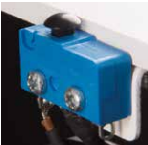
Figure 4 : Interrupteur de fin de course de sécurité 1
