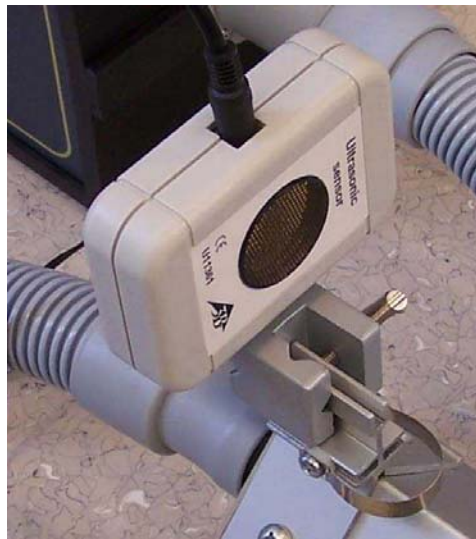
Fig. 2 : Vue détaillée de la fixation du boîtier capteurs sur le banc à coussin d'air
