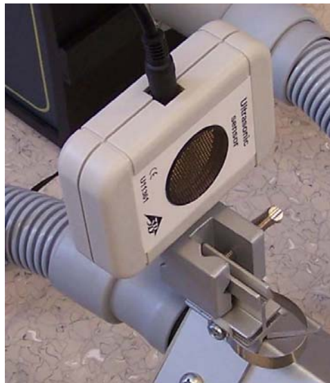
Fig. 2: Detailansicht der Sensorboxbefestigung auf der Luftkissenfahrbahn
