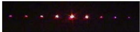
Fig. 7 Structures de diffraction d'un réseau de diffraction
