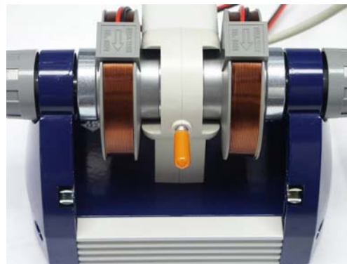
Fig. 4 Unité de base avec échantillon de DPPH
