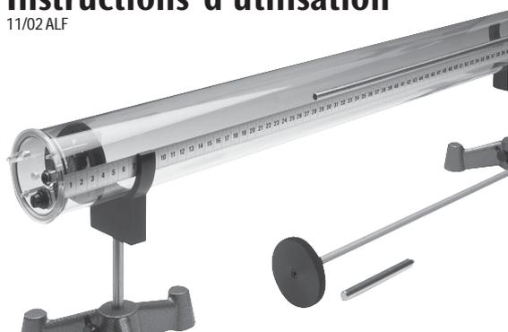
Le jeu d'appareils constitué du tube de Kundt et de ses accessoires permet d'illustrer les ondes acoustiques stationnaires avec des extrémités de tube ouvertes ou fermées ainsi que de déterminer la longueur d'onde dans l'air ou dans d'autres gaz.
