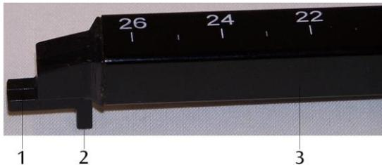
Sonde de champs magnétiques : 1 sonde de Hall tangentielle (direction Z), 2 sondes de Hall axiale (direction X), 3 supports
