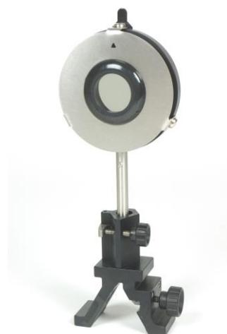
Fig. 1 : Élément de polarisation monté sur la plaque de quart de longueur d'onde.
