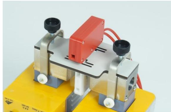
Fig. 1 : Lampe Cd montée sur l'électroaimant.
