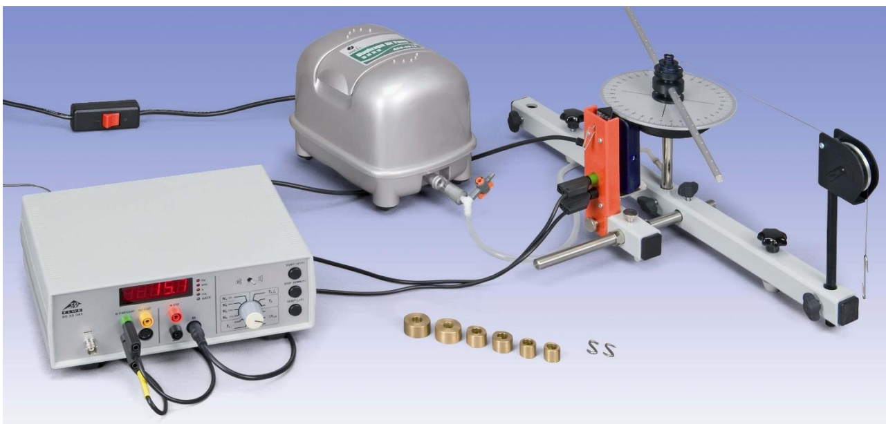
Fig. 1 : Agencement expérimental permettant d'examiner des mouvements de rotation à accélération uniforme
